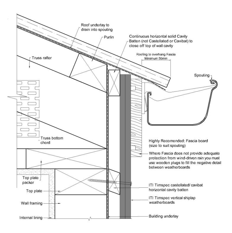
VC 602 Roof/ Wall Top Plate - No Soffit
